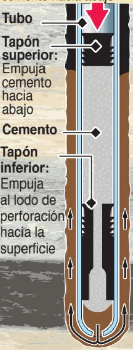
**3** El cemento se empuja a través del tapón inferior y llena el espacio entre el tubo y el hoyo perforado
